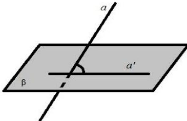
Рис. 15. Угол между прямой и плоскостью
