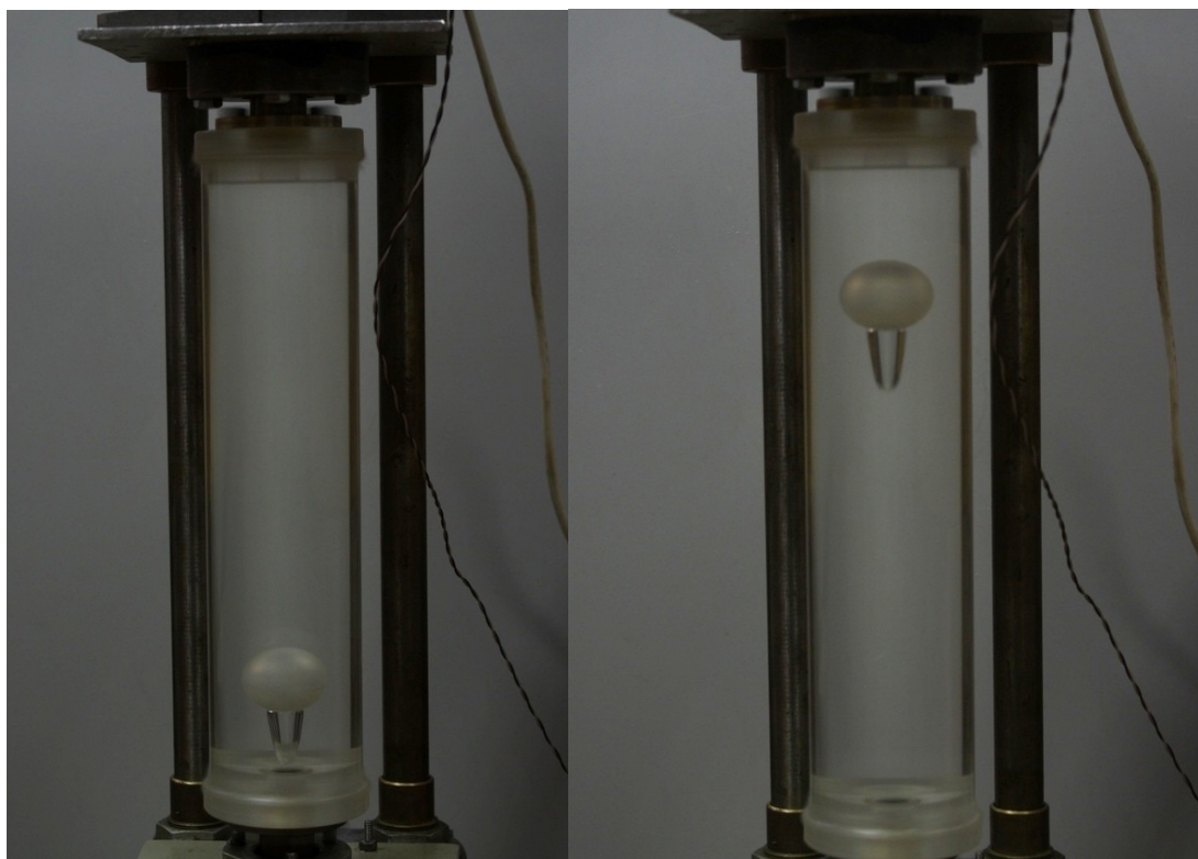
Рис. 2.4 Фотография всплытия шарика при вращении кюветы
