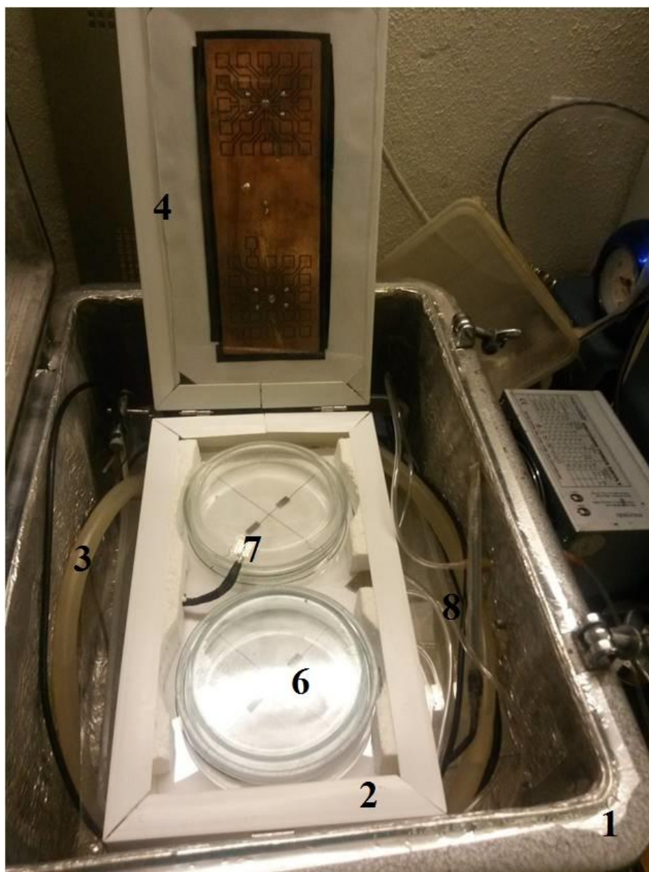
Рис.3 Жидкостный термостат-облучатель для инкубаций бактерий на агаризованных средах
