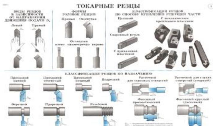
Рис 2. Плакат. Виды токарных резцов
