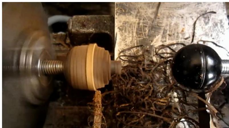
Рис 14 Точение шара на токарном станке
