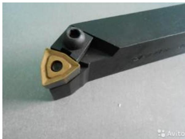
Рис 1 резец со сменной рабочей пластинкой
